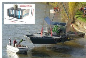
Photo = Turbine test d'HydroQuest à Orléans : 30 kW
